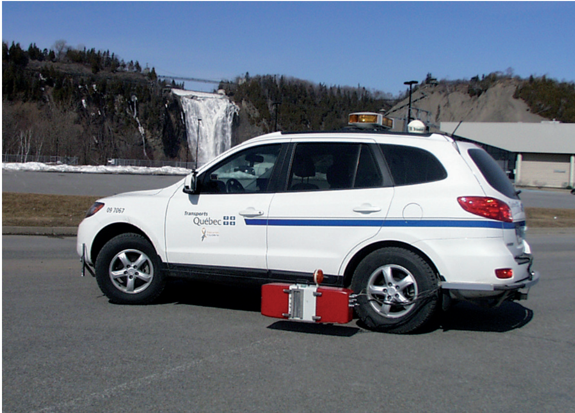
Figure 21 Rétroreflectomètre mobile (ECODYN).
